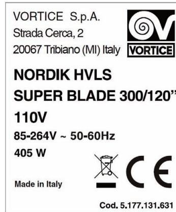
Fig. 1 - Beispiel Typenschild für SUPERBLADE 300/120" 110V
